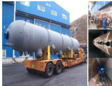
HRSG Steam Drums
